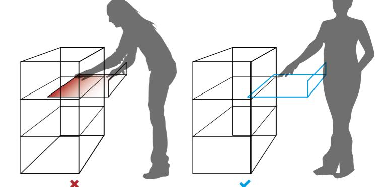
**La posibilidad de utilizar la extracción total para cajones y gavetas** amplía la visión para la recogida de los utensilios almacenados.
